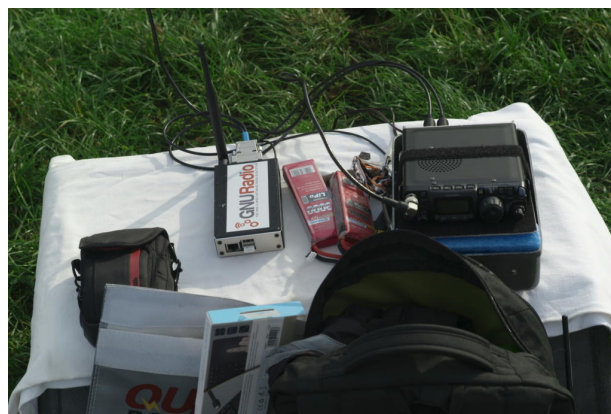
Abb. 2: Station, bestehend aus FT817 und einem Raspberry Pi
