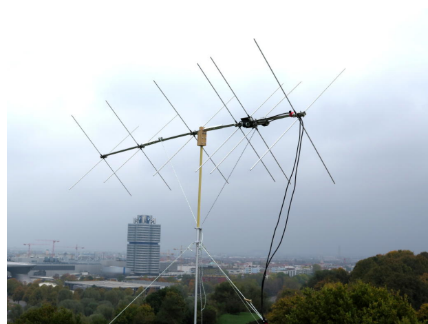
Abb. 1: 2m 6El. Yagi nach DK7ZB, als Kreuzyagi ausgeführt - Quelle: Sven (DG1SVE)
